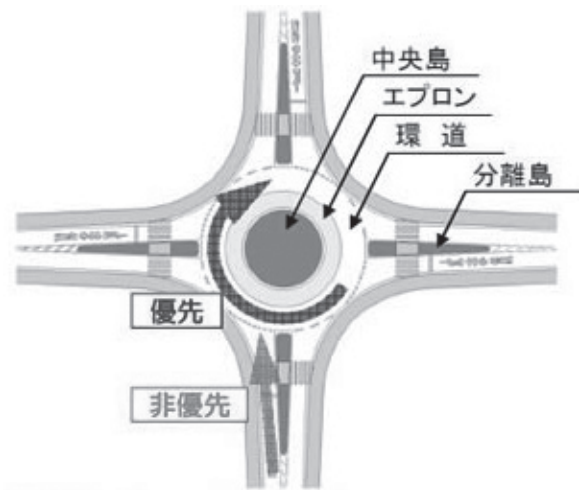
ラウンドアバウト交差点の概要図 交差点内は時計まわり
