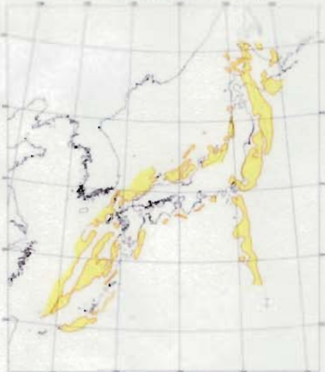
石油・天然ガス賦存ポテンシャルの高いエリア (堆積量2000m以上の堆積盆)
