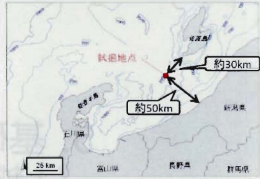
（試掘地点）新潟県佐渡南西沖約30km、水深約1,100m、掘削深度海底面下約2,700m
